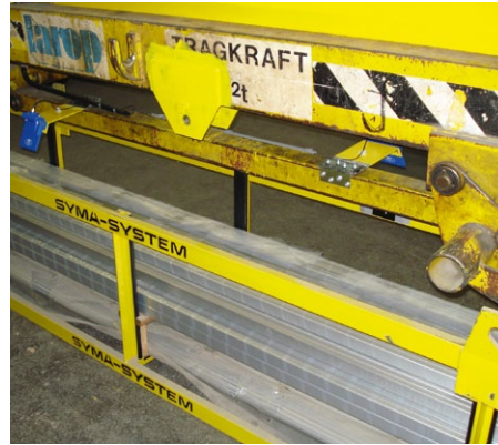
RFID-System auf Anhängervorrichtung des Krans
