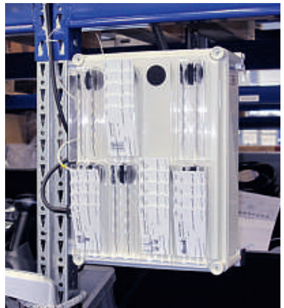
Jeder Kartenleser kann bis zu 36 Karten gleichzeitig identifizieren. (Bilder: TR)
